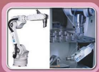
機器人裝卸工件自動化
